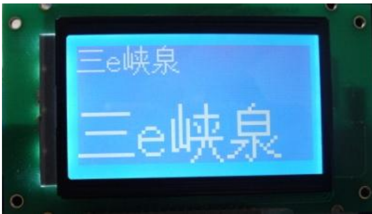
128*64 点阵液晶显示 16*16/32*32 点阵文字
